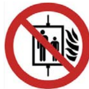
Abb. 20 erforderliche Kennzeichnung des Aufzugs in jeder Ebene und im Fahrkorb
